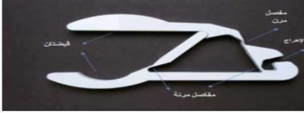
الشكل (2) يمثل آلة بأجزاء مرنة
